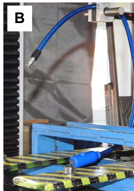
Destrukce při zatížení silou 1,040 kN
