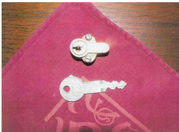
Unikátní oboustranný klíč a tím i nejkratší známá vložka
